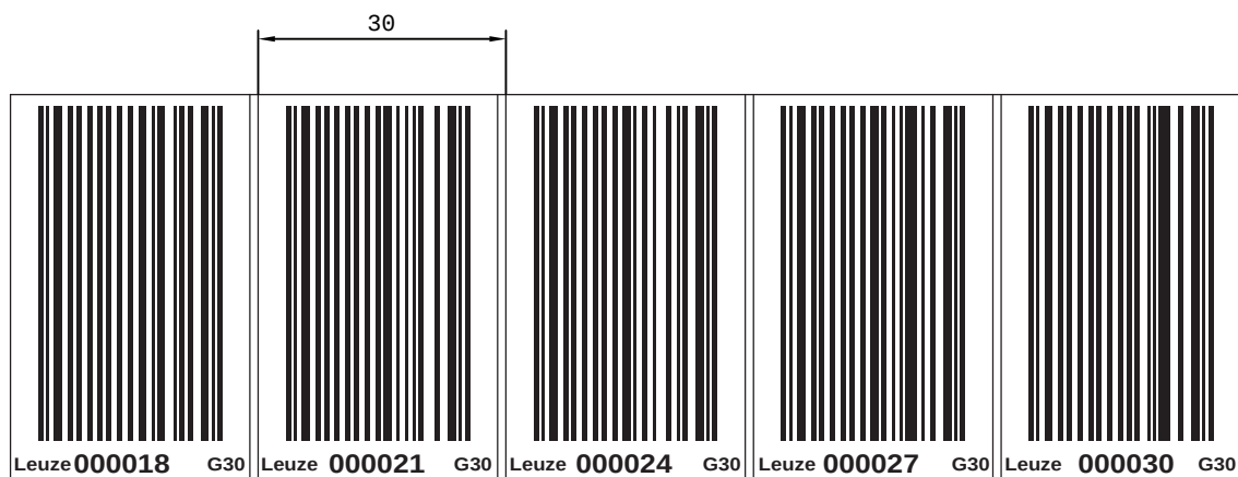
Fig. 12.2: Vérification du résultat de l'impression du kit de réparation BCB G30 ... (quadrillage de 30 mm)
